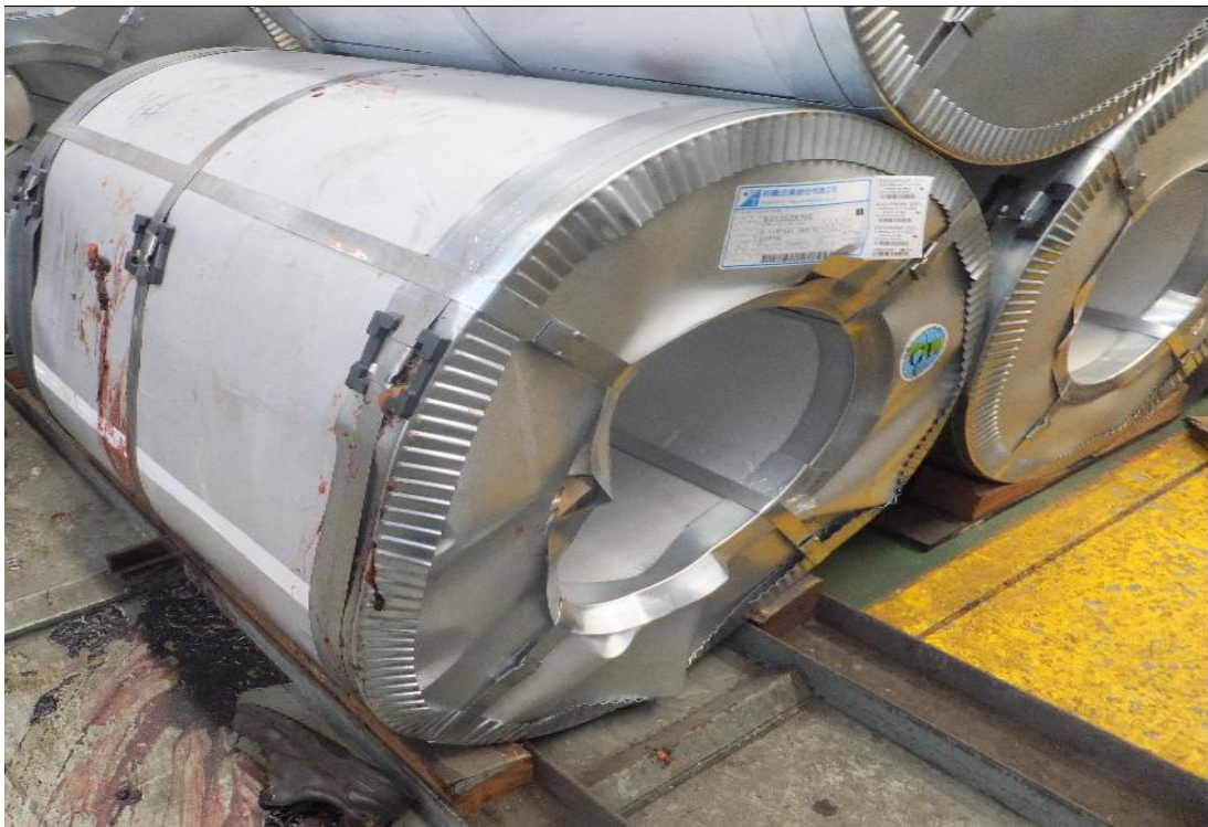
說明二 肇災鋼捲重約 10 公噸。
