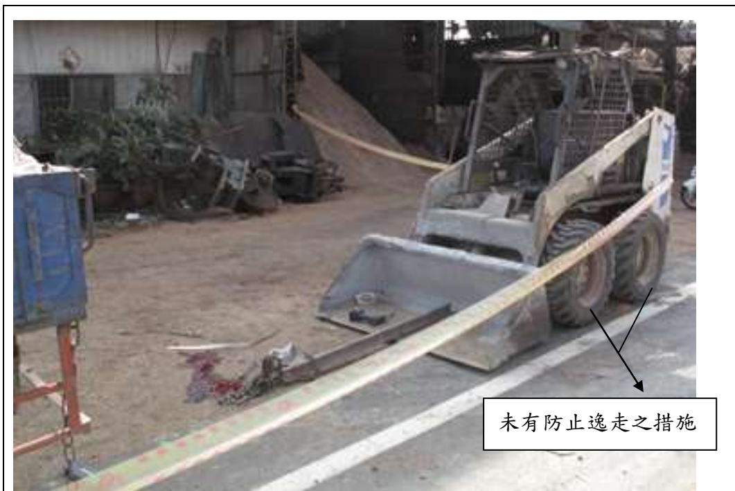
說明 (照片 2) 肇災鏟裝機所停位置為農路旁之平坦空地，而其前後輪均未有設置防止其逸走之措施
